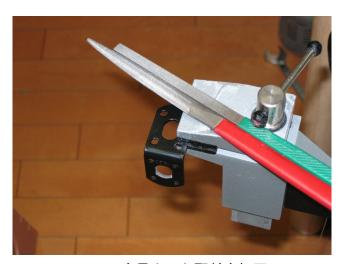
t0022(L金具ナット取付穴加工)
