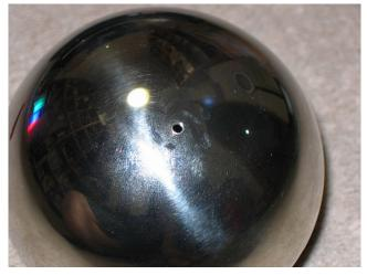
t0001(高電圧電極(ねじ穴加工済))
