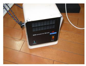
t0039(接着剤飛散防止のためイオナイザー稼働)
